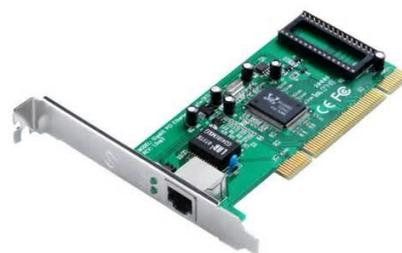
Puede ser para cable (tipo **Ethernet**), inalámbrica (**Wireless PCI**) o inalámbrica USB (**Wireless USB**). Ésta última no se conecta a la placa base, sino que se conecta mediante USB. También existen tarjetas de red más pequeñas específicas para ordenadores portátiles (**MiniPCI Inalámbrica**).
